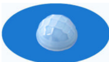
Type : 7709-6 focus : 5 angle : 90 ° distance : 5m dimension : Φ16.6 inner: Φ15
