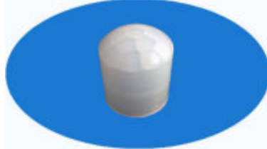
Type : 8308-2 (circular cylinder) focus : 9.0 angle : 140 ° distance : 8m dimension : \Phi 12.5 high:14.30
