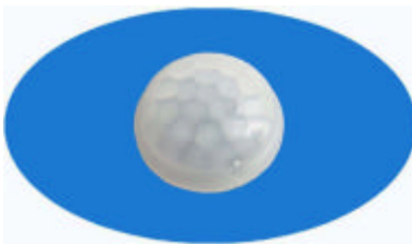
Type : 8014 focus : 6 angle : 120 ° distance : 5m dimension : outer dimension \Phi 16 inner \Phi 14
