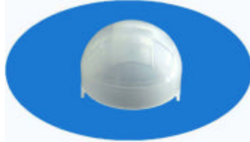
Type : 7709-1A focus : 8 angle : 90 ° distance : 8m dimension : \Phi 20.8
